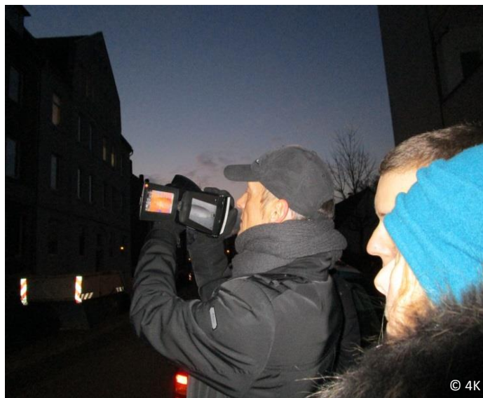
Die Eigentümer*innen erkennen durch die Thermografie-Aufnahmen vorhandene Wärmelecks an Wänden, Dächern, Fenstern und Türen.
